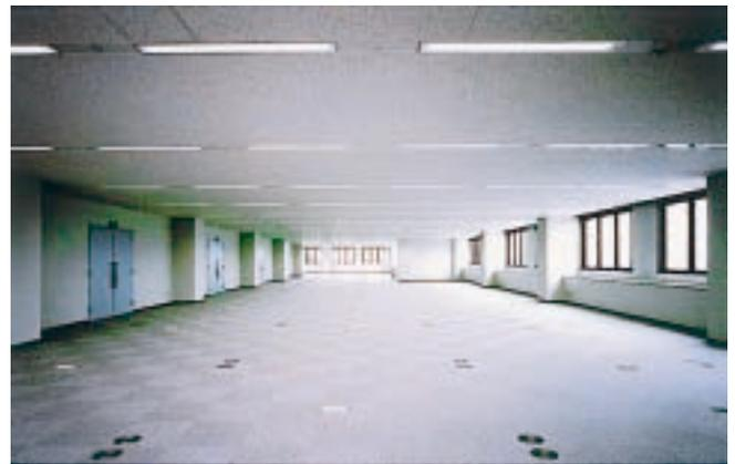
▲床吹き出し空調と自由制御照明で省エネルギーを図っています。
