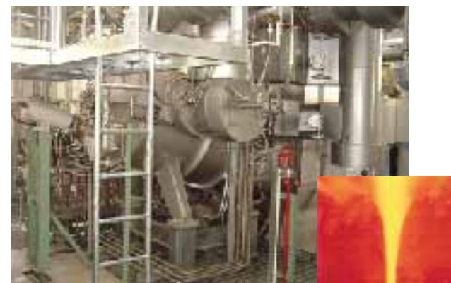
●溶融炉本体 下水汚泥の焼却灰を高温で溶融し、スラグにします。
